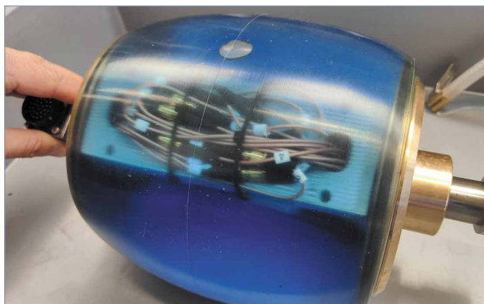
SONDA A RUOTA: per controllo tubi e tondi su impianti automatici. Possibilità di personalizzazione.
