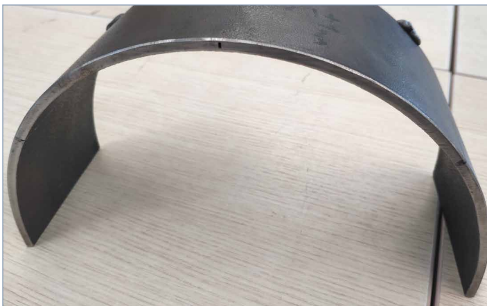
Realizzazione intagli superficiali e sub superficiali (dimensioni 2x0.5x30 mm) su geometrie di piccole dimensioni.
