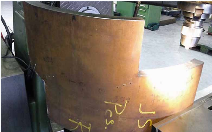
Lavorazione tubo campione per calibrazione di controllo PAUT e TOFD.
