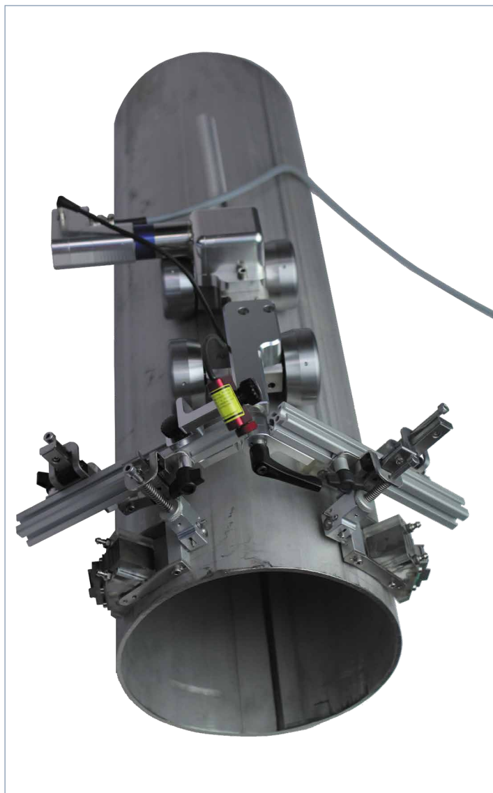
Controllo saldature longitudinali su tubazioni da diametro 130 mm con ruote magnetiche dedicate.
